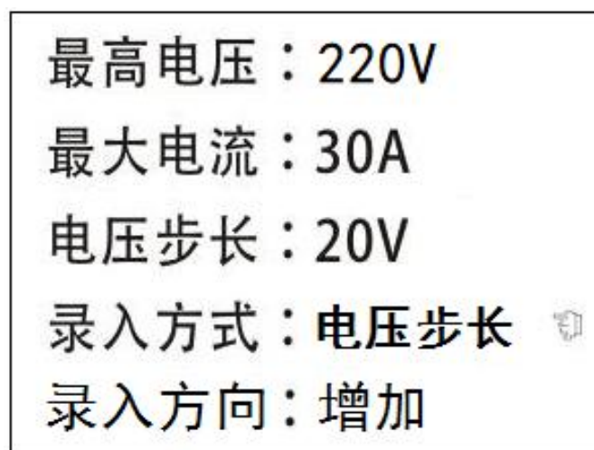
图 6-20 单相变压器空载试验设置
